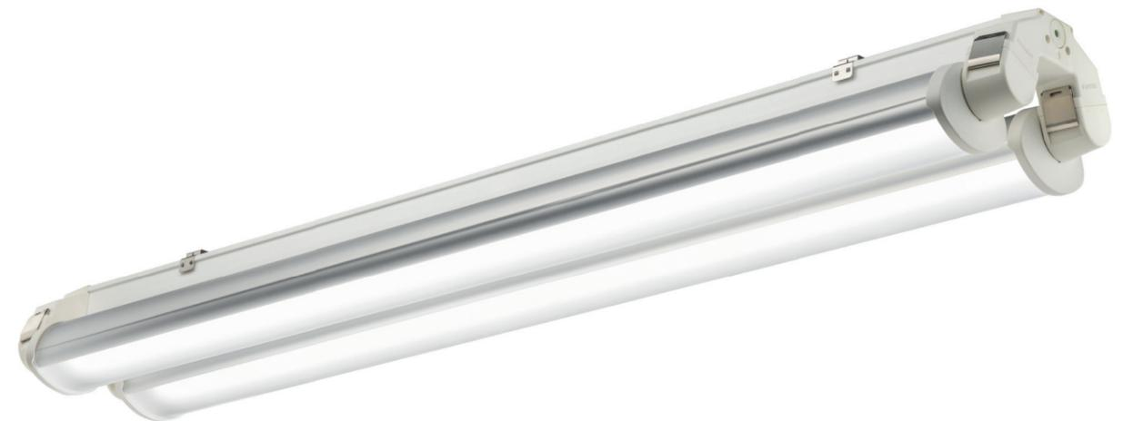
**APOLLO N LED DB** Mit einem oder zwei Reflektor/en (180° schwenkbar), Ra > 90, Farbtemperatur 4000 K, Ta: -25°C ... +45°C, Überspannungsschutz, SKIIL.
